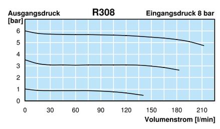
\*1 bei Druckluft 8 bar Eingangsdruck, 6 bar Ausgangsdruck und 1 bar Druckabfall
